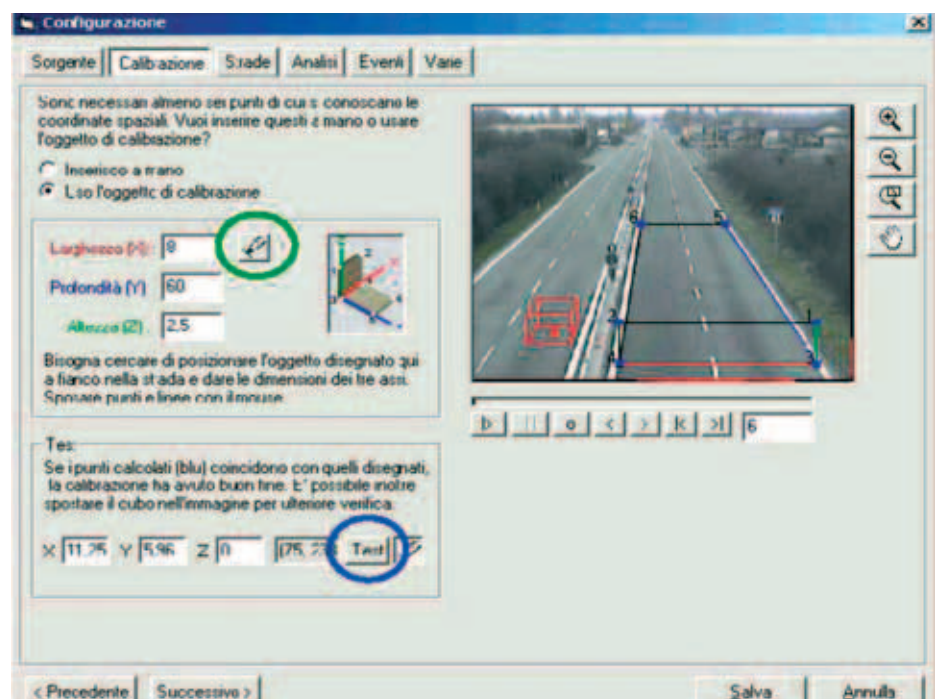
Funzione di configurazione del sistema del software di monitoraggio del traffico e di rilevazione automatica degli incidenti.
